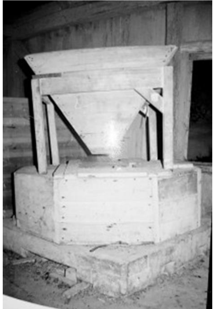
Jyvät kaadettiin suppiloon, josta ne valuiivat myllynkivien vä- liin. Pyörivät kivet oli koteloitu lauta-arkkuun.
